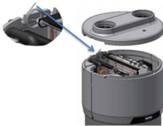
Fig. 14 – Câble pour connexion à distance
