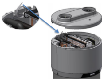
Fig. 14 – Câble pour connexion à distance
